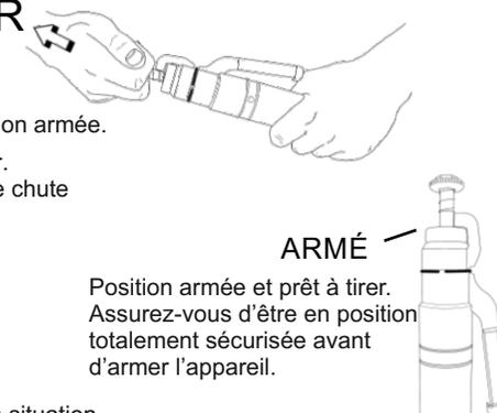
Position armée et prêt à tirer. Assurez-vous d'être en position totalement sécurisée avant d'armer l'appareil.
